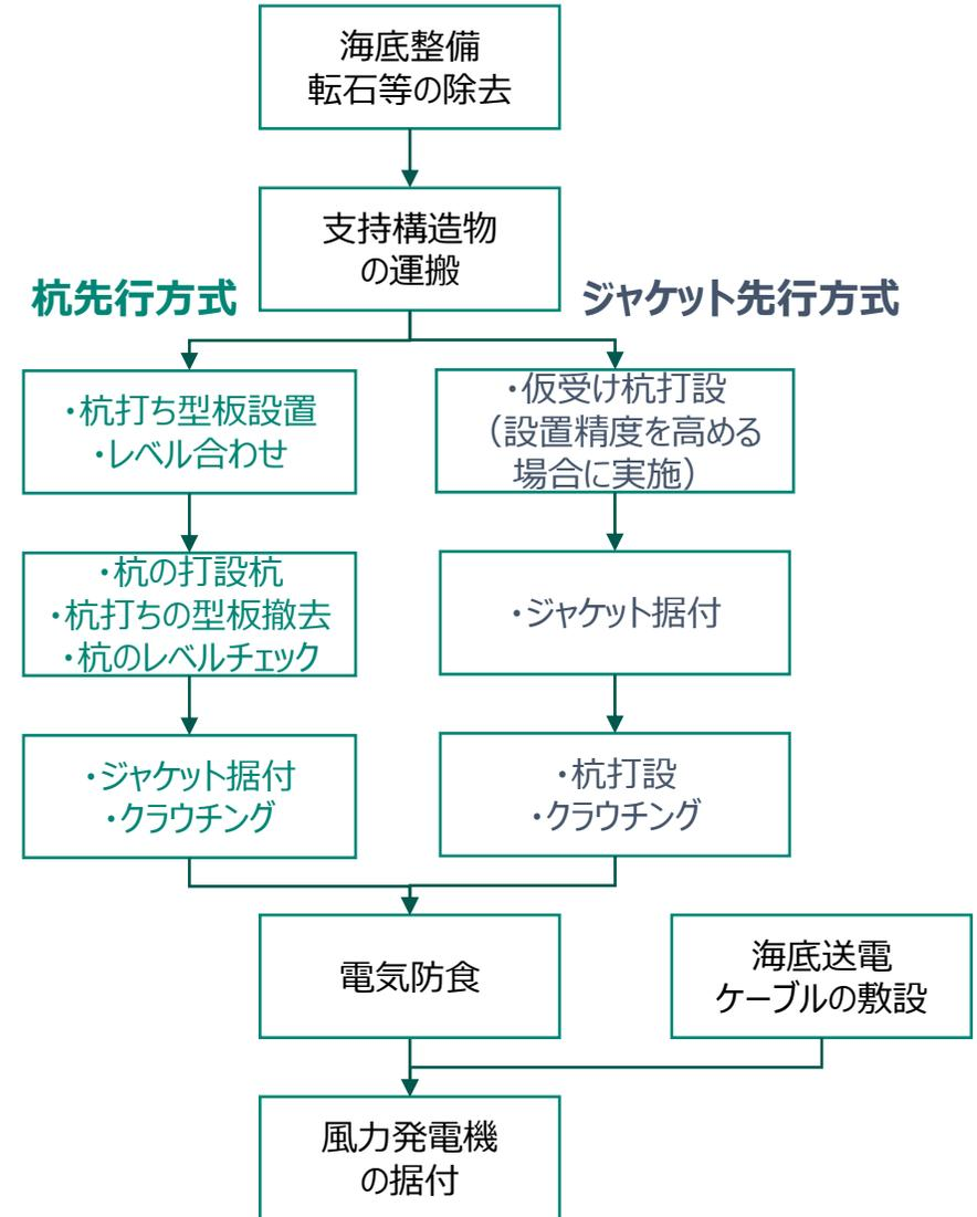
図 ジャケット式の施工の流れ
