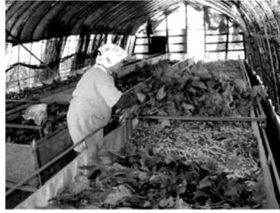
図 2 . 給桑台車付糸桑飼育装置による飼育
