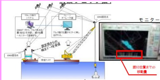
▲ICT機器や3Dモデルの活用による消波がらみ据付の効率化 (R6インフラDX大賞)
