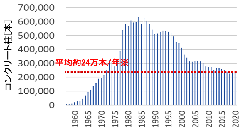
〔コンクリート柱の経年分布〕
