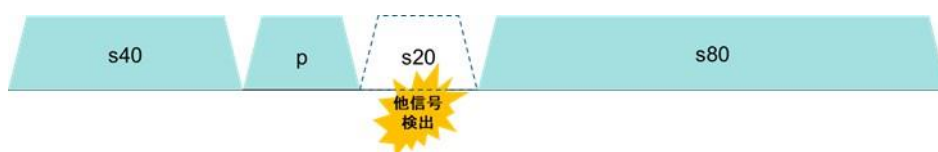
図 3－6 160 MHz チャンネル幅使用時に secondary 20 MHz channel に他信号があり、ビジーとなる場合のパルクチャリング適用送信例
