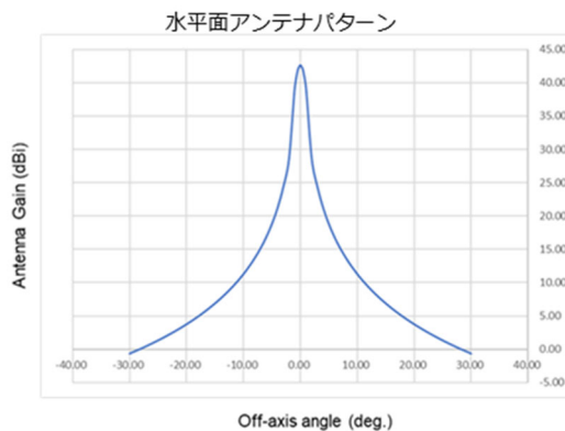
図 2. 3. 3. 3-4 GW 一般業務用固定局の指向性減衰特性
