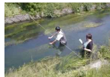
流速観測状況
