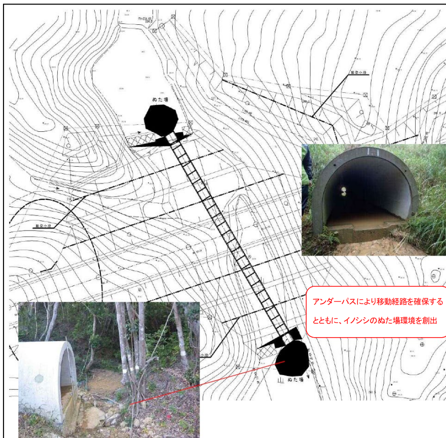
アンダーパスの設置
