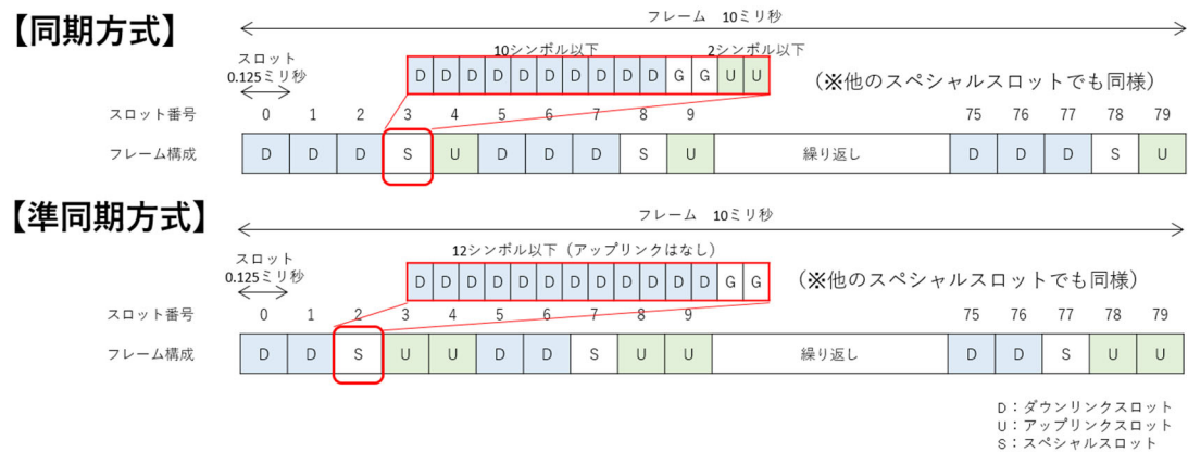
図 2 28.2～29.1GHzの周波数帯における送信装置のフレーム構成
