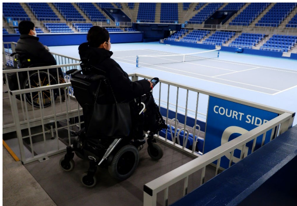
・改修により、屋内テニスコートの観覧席に設けられた車椅子使用者用客席（客席2段分のスペースを使って改修を実施）
