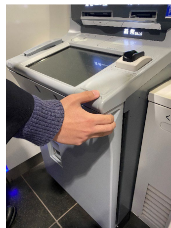
・車椅子使用者が身体を引き寄せやすいよう、操作機の左右にハンドグリップを装備したATM
