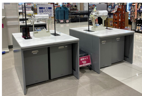
・サッカー台（上端高さ：72cm、下端高さ：68cm）
