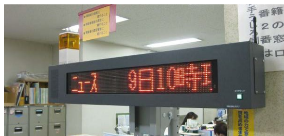
・LED電光表示板（上部に設けられているのは、緊急情報の表示と連動した回転灯とニュースや緊急情報を受信するアンテナ）
