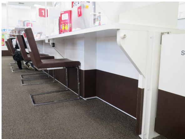
・ローカウンター（下端高さ：70cm、上端高さ：73cm、奥行：40cm）
