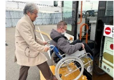
図 自動運転バスの停留所形状と車椅子乗降検証の実証実験
