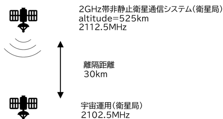
図2. 4. 2-1 2GHz帯非静止衛星通信システム(衛星局)から宇宙運用システム(衛星局)への与干渉への1対1対向モデル
