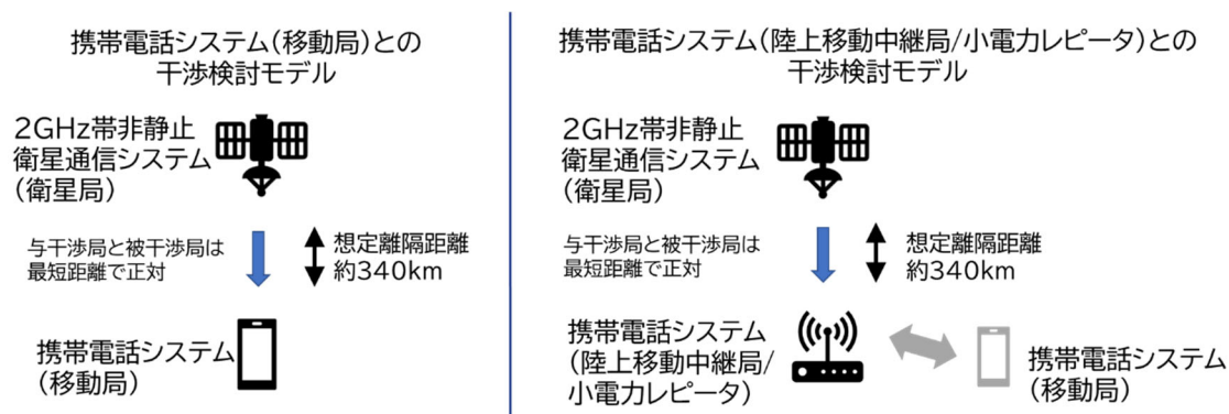
図2.3.2-2 2GHz帯非静止衛星通信システム(衛星局)から移動通信システム(移動局)への与干渉の1対1対向モデル
