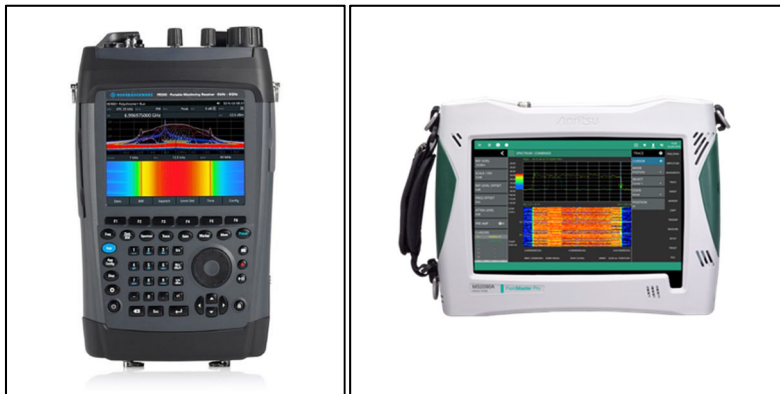
図 28 可搬型スペクトラムアナライザ例
