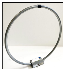
図 3 シールドドロープアンテナの例
