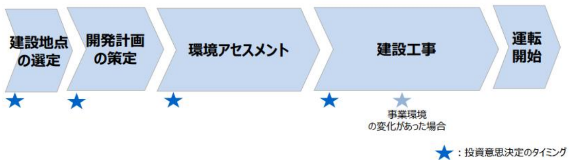
(参考図 13) 火力発電所の建設プロセス
