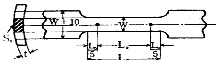
図 引張試験における試験片の寸法及び形状
