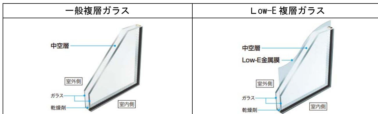
図3：複層ガラスの構造
