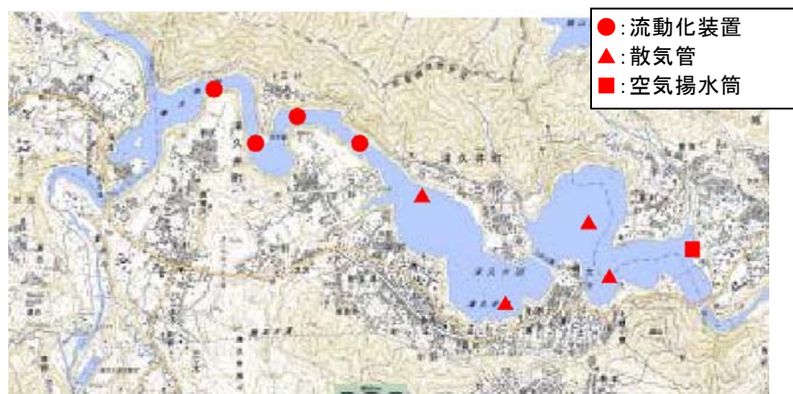
図 4.9 城山ダム（津久井湖）曝気循環装置設置位置
