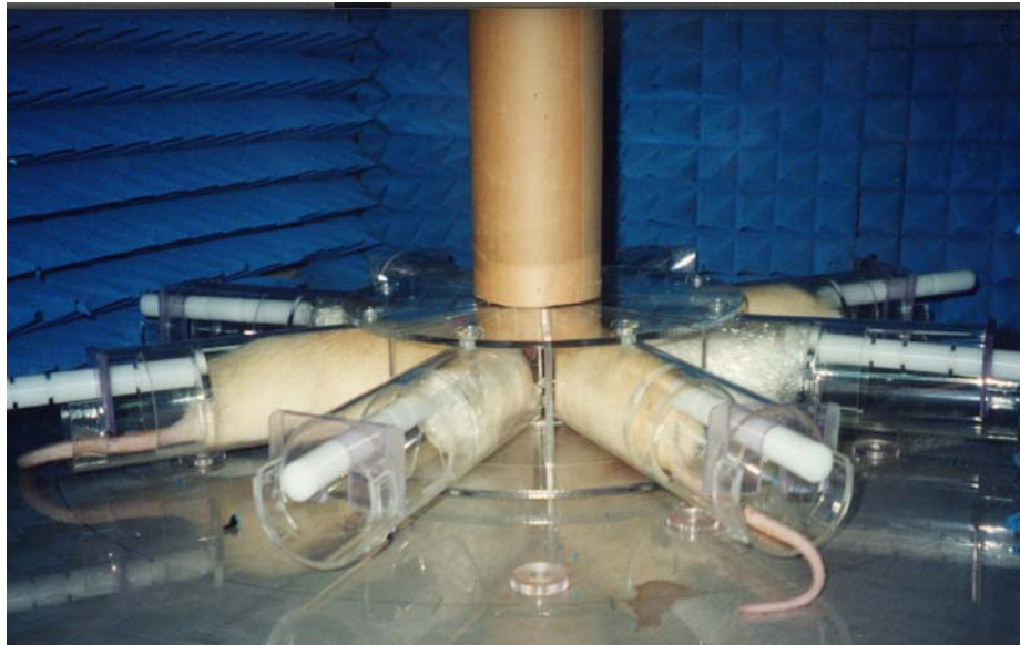
ラットの頭部への電波ばく露
