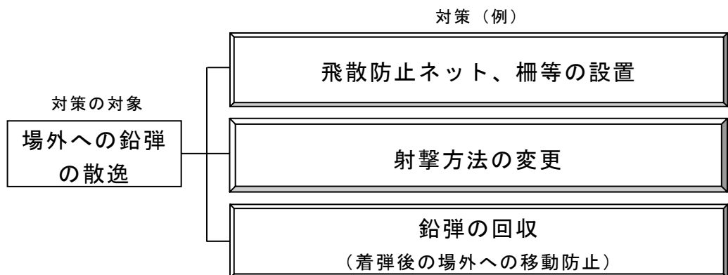
図３－４ 鉛汚染問題の解消を対策目的とした場合の対策の例③ （場外への鉛弾の散逸を対策の対象とした場合）
